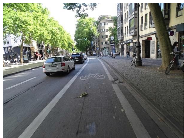
Abbildung 7 Beispiele für Radfahrstreifen im Zuge von Fahrstreifenreduzierungen (Hildesheimer Straße, Hannover (links) und Habsburger Ring, Köln (rechts))
