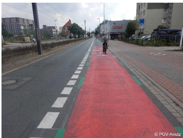
Abbildung 7 Beispiele für Radfahrstreifen im Zuge von Fahrstreifenreduzierungen (Hildesheimer Straße, Hannover (links) und Habsburger Ring, Köln (rechts))
