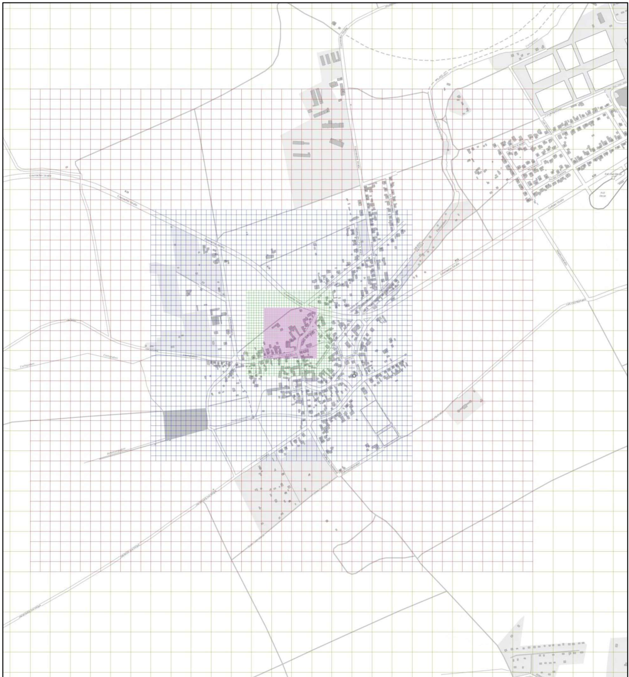
Abbildung 4: Verwendetes Rechengebiet mit Diskretisierung in Rechengitter (Ausschnitt)
