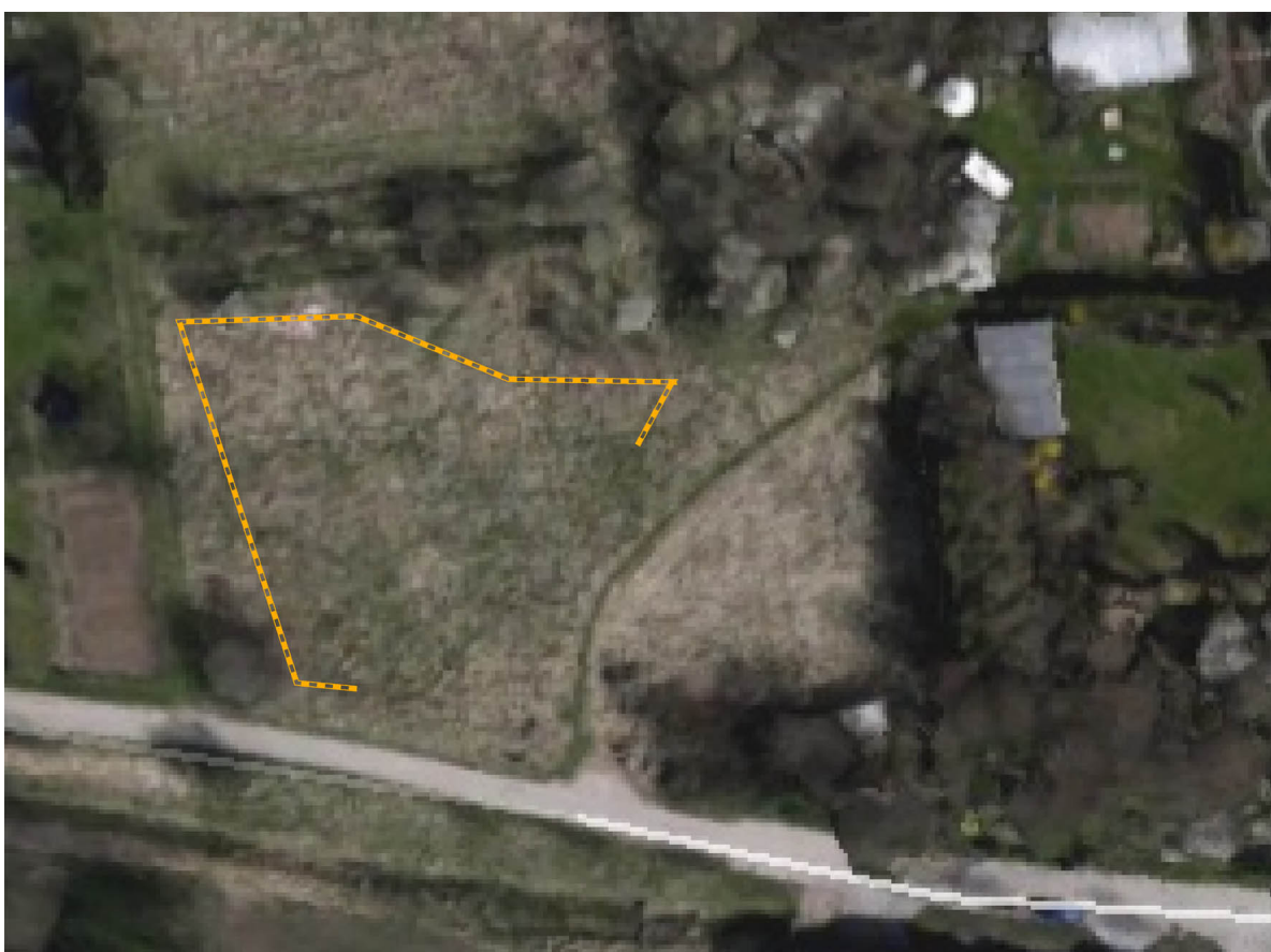
Kartenskizze 4: Vorgeschlagener Verlauf des Fangzaunes (orange Linie) im Südwestteil des Planungsraumes zum Abfangen der Reptilien und zum Schutz gegen Rückwanderung (ggf. örtliche Anpassung in Abhängigkeit vom Baufortschritt erforderlich)
