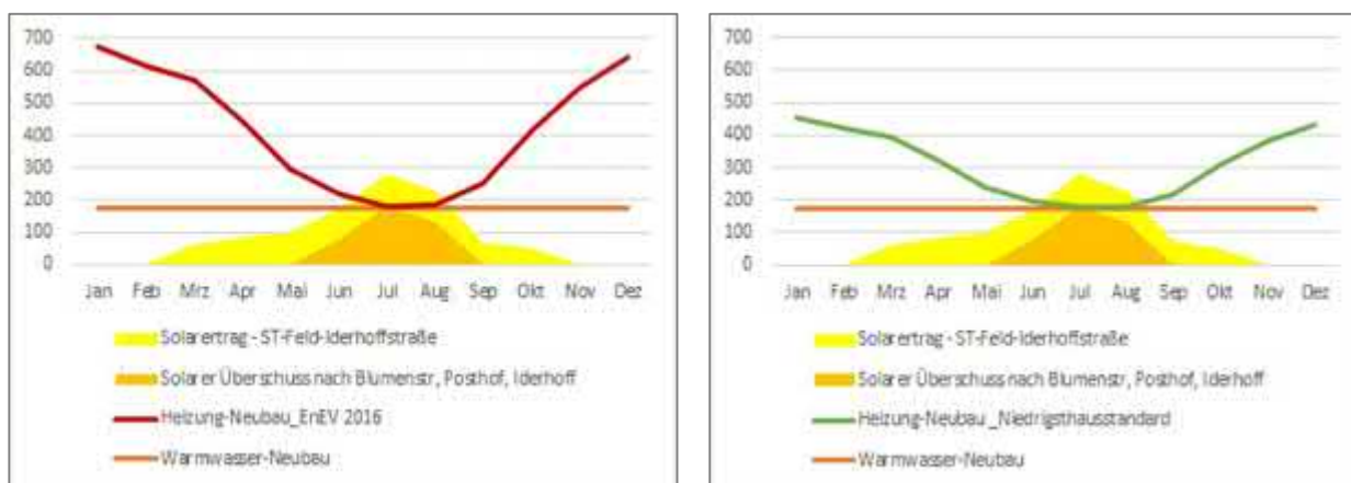
Abbildung 52: Quartierszenario Stadtwerke, Gegenüberstellung von Wärmebedarfs und Solarthermie Potential: links EnEV- 2016 Standard, rechts Niedrigsthausstandard
