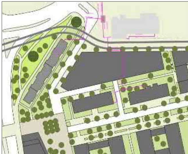
Abbildung 33: Fernwärme-Anbindung der ICE-City. Aufgrund der Errichtung des neuen Parkhauses ist eine Neuverlegung der bestehenden Anschlüsse zu den Gebäuden „Zum Güterbahnhof 7 +8“ erforderlich.
